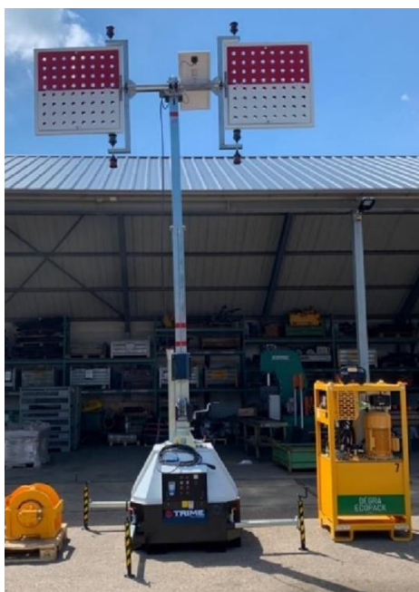
Navigatiemast voorzien van zonnepanelen en accu's, eco-hydrauliek unit tbv spudpalen
